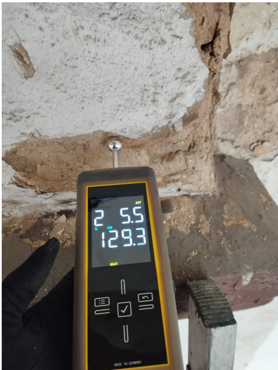
fot. nr 18. Elewacja południowa, badanie wilgotnościomierzem stanu zawilgocenia murów, grudzień 2022 r.
